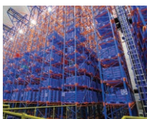
AS/RS ในห้องแช่แข็ง รองรับอุณหภูมิติดลบได้ ถึง 60 °C
